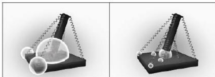
Fig. 1 Ilustración gráfica del efecto calculado que ejerce la fuerza cerca del eje de la articulación (dibujo derecho) y una carga determinada para un mástil sostenido con muelles grandes y pequeños oscilando alrededor de su posición de equilibrio. Las esferas en el punto de inserción de los muelles y en la articulación del mástil indican la magnitud de las fuerzas en estos puntos para ambos casos: calzado de control y calzado MBT.
